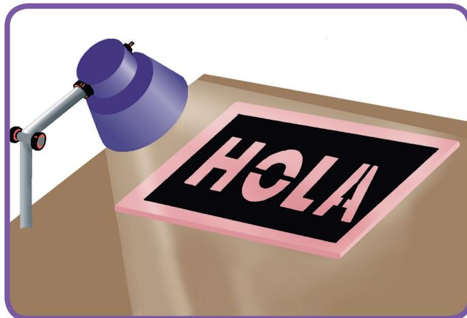
5. La lámpara proporcionará calor y el papel secante pasará de rosado a un color oscuro en la parte recortada correspondiente a las letras. De este modo, el mensaje quedará grabado sobre el papel secante.
